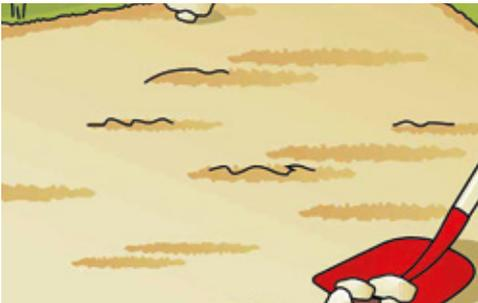
Gewachsenen Boden einebnen (Gefälle ca. 1%) von der Terrasse in den Garten). Steine und Unkraut entfernen. Unebenheiten beseitigen durch Auffüllen und Verdichten. Sollte der Boden nicht gewachsen sein, ein 30 cm tiefes Bett ausheben und mit Schotter, Splitt und Sand auffüllen, wobei jede einzelne Lage verdichtet werden muss!
