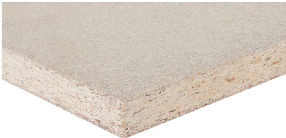
Spanplatten bestehen zu 90 bis 97 % aus Holzspänen.
