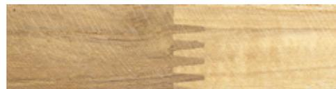
Plattenaufbau mit keilgezinkten Lamellen
