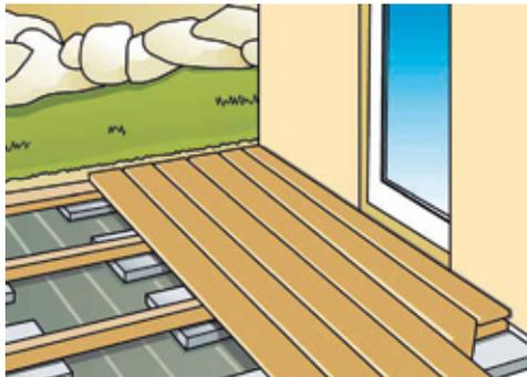
Beginnen Sie bei parallel zur Hauswand verlegten Dielen an der Hauswand. Beachten Sie einen Dehnungsabstand zur Hauswand von mind. 10–15 mm und einen Fugenabstand von 3–8 mm je nach Holzart, Produkttyp und Herstellerempfehlungen.
