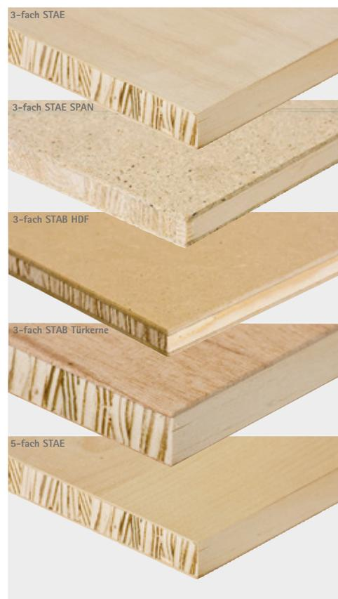
Mittellage aus vollverleimten Fichtenstäben nach DIN 68705. Verleimung IF 20 gem. Gefahrstoffverordnung S9 Abs. 3. Emissionsklasse E1. Weitere Holzarten und Furniere, Formate, Dicken (bei Trägern und Deckflächen) und Verleimung AW 100 auf Anfrage möglich.
