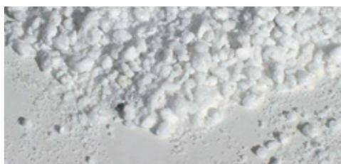
▷ Mineralischer Schüttdämmstoff aus thermisch expandiertem Mineral (Perlite, Bims, Glas, Ton)
