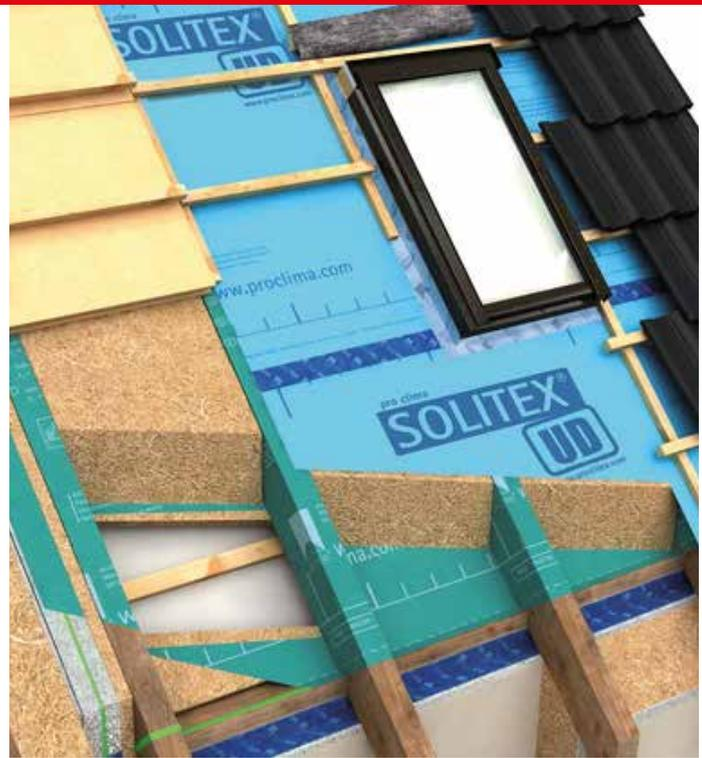
Zwei unterschiedliche Dämmprinzipien für die Dachsanierung von außen: Mit Anordnung der luftdichten Ebene oberhalb der Sparren (links) oder mit schlaufenförmiger Verlegung der luftdichtenden Bahnen (rechts). (rechts). Grafiken: po clima
