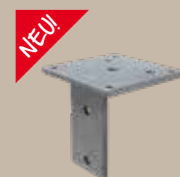
L-Steinadapter passend für alle Konsolen im HQ-Zaunsortiment, Stahl feuerverzinkt, Maße 16 x 16 cm Art.-Nr. 20040134
