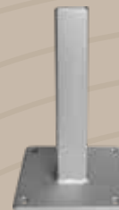
Konsole GJ45 zum Aufdübeln, Stahl feuerverzinkt, für WPC Pfosten, Maße: 16 x 16 x 40,8 cm
