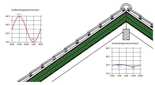
Was für den Wärmeschutz im Winter der U-Wert ist, sind im sommerlichen Wärmeschutz Amplitudendämpfung und Phasenverschiebung. Während die Amplitudendämpfung zeigt, wie stark der Temperaturdurchgang durch das Bauteil gemindert wird, gibt die Phasenverschiebung an, um wie viele Stunden der Durchgang der Maximaltemperaturen verzögert wird.
