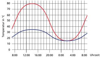
Temperatur unter der Dachdeckung Außentemperatur
